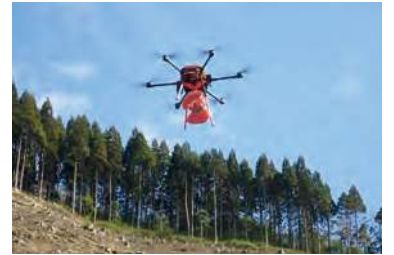
ドローンウインチシステムによる 資材搬送の様子
