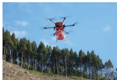
ドローンウインチシステムによる 資材搬送の様子
